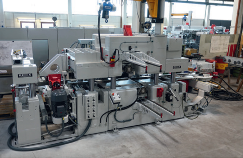
Mit dem Supermaster HC verspricht Rex eine minimale Spanabnahme von nur 0,5 bis 0,75 mm pro Seite
