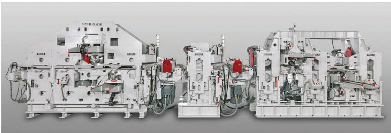
Mit bis zu 500 m/min ist der Speedmaster von Rex auf Hochleistung ausgelegt. Dennoch ist die Hobelanlage ausgesprochen flexibel einsetzbar
