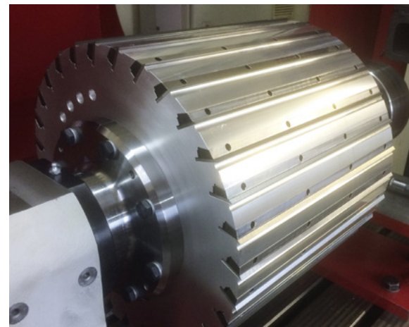
Mit der neuen Messerspannung konnte Rex bei der Befestigung 50% der Schrauben einsparen – dies bedeutet einen enormen Zeitvorteil
